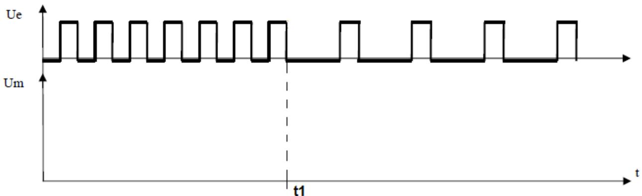
Lorsque la valeur moyenne de  $U_m = 12V$ , la fréquence de rotation du moteur =  $f_{max}$ .
