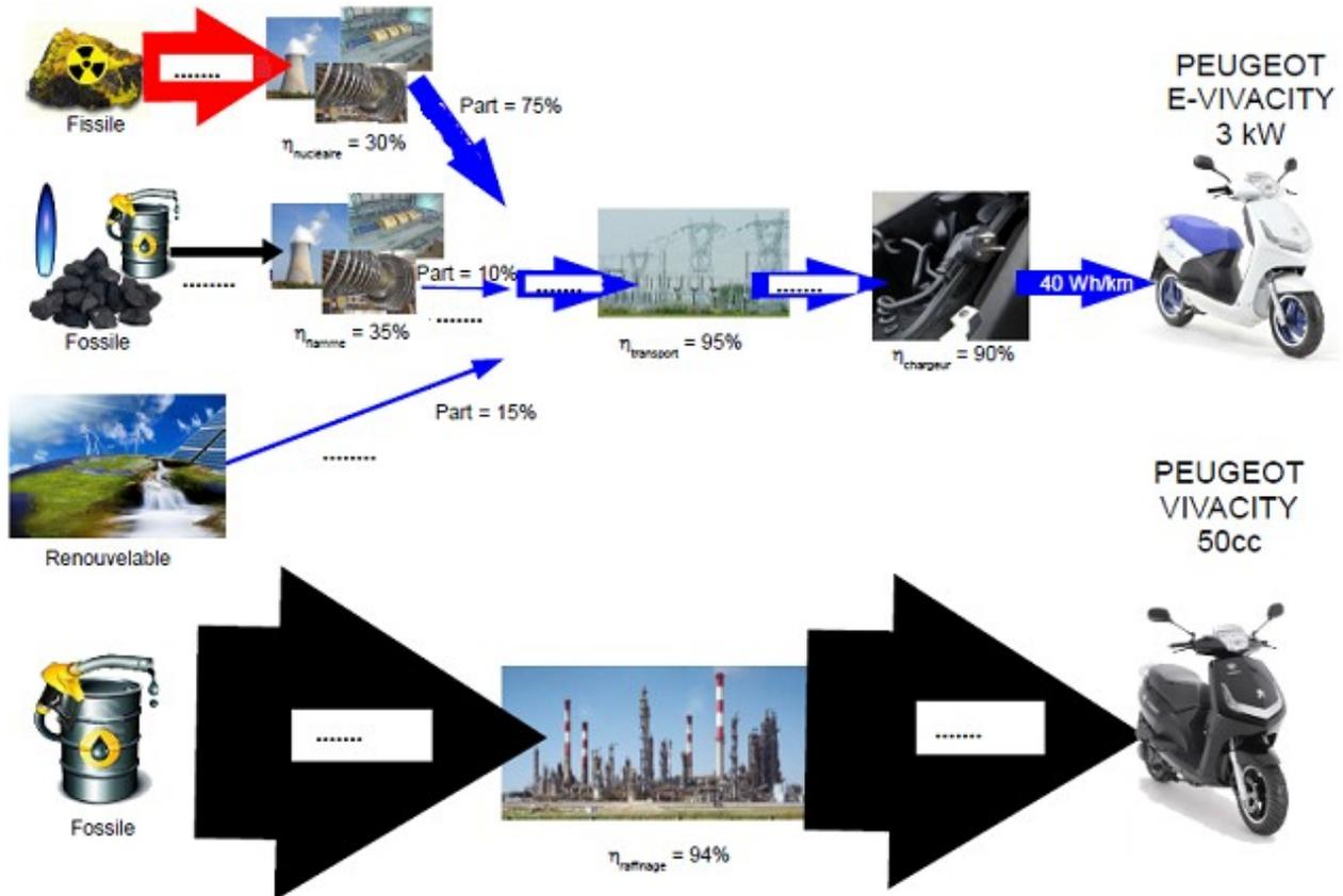
*rendements et des répartitions de la chaîne de production d'électricité*
