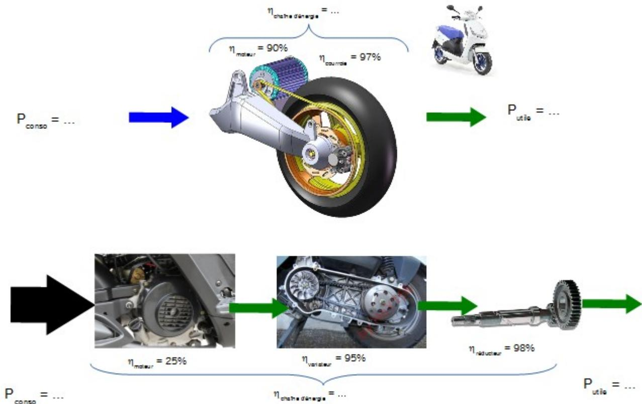
rendements des différents éléments de transformation ou de transmission
