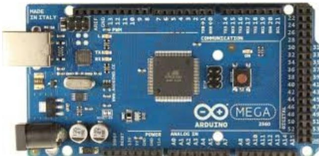
La carte Arduino méga sera programmée par le Simulink, un module de Matlab. La carte méga comme cible de Simulink permet un fonctionnement connecté au PC et facilite l'acquisition des données en cours d'expérience.
