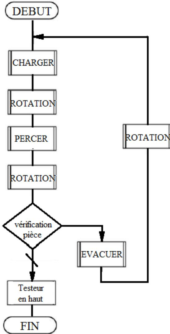
NB : le sous programme "percer" inclus les commandes de serrage/déserrage
