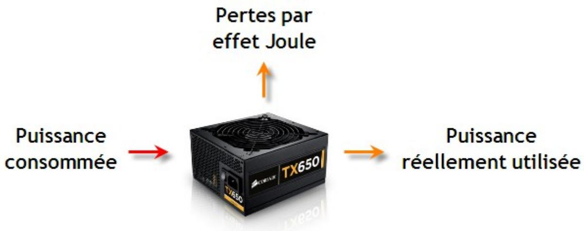
Depuis 2007, le label 80 Plus a été mis en place afin de garantir un rendement acceptable pour les alimentations du commerce. « Acceptable » signifie que les pertes n'excèdent pas 20%. Autrement dit, le rendement doit être d'au moins 80%.
