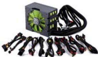
NB : certaines alimentations dites « modulaires » permettent de débrancher les câbles inutilisés. Cela dans le but de ne pas encombrer l'espace et ainsi de permettre une meilleure circulation de l'air dans le boîtier.
