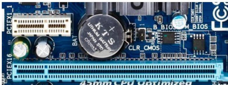
*En haut (en blanc) : un port PCIe 2.0 x1. En bas (en bleu) : un port PCIe 2.0 x16.*
