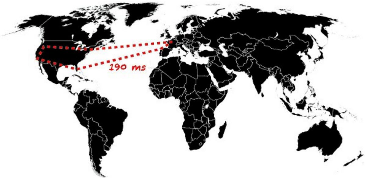
Pour bien dimensionner son temporisateur, TCP va se baser sur une estimation du délai d'aller-retour séparant l'émetteur et le récepteur. Le délai d'aller retour est défini comme le temps séparant l'envoi d'un segment de la réception de l'acquittement correspondant. TCP va essayer d'estimer une moyenne de ce délai, mais ne va pas réaliser cette moyenne sur l'intégralité des segments depuis le début de la transmission, mais plutôt sur les quelques derniers segments de la transmission.
