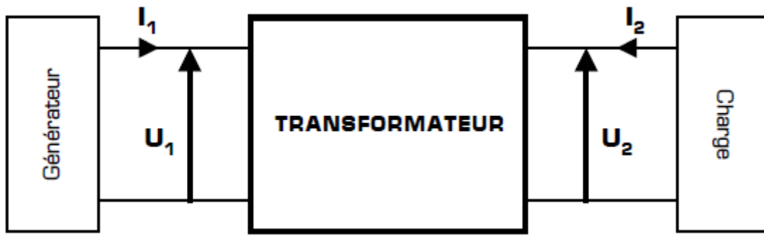
Transformateur en fonctionnement
