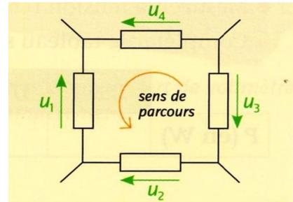
Une maille est un chemin fermé, passant par différents points d'un circuit électrique.
