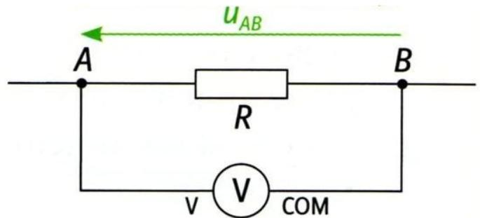
**Pour mesurer la tension  $U_{AB}$**  entre deux points A et B d'un circuit, il suffit de réaliser son circuit, puis de relier la borne V du multimètre (borne ..... ) au point A et la borne COM (borne ..... ) au point B. Si on réalise les branchements contraires, on mesurera la tension  $U_{BA}$ .
