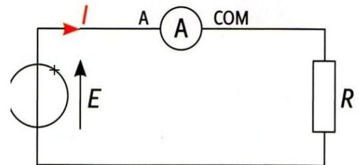
L'intensité du courant **se mesure** grâce à un **ampèremètre** de symbole
