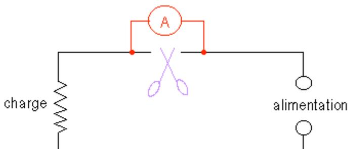
pour mesurer de l'intensité du courant en un point A du circuit, il faut donc placer l'ampèremètre au point A. Il faut donc défaire son circuit pour pouvoir y intercaler l'ampèremètre !
