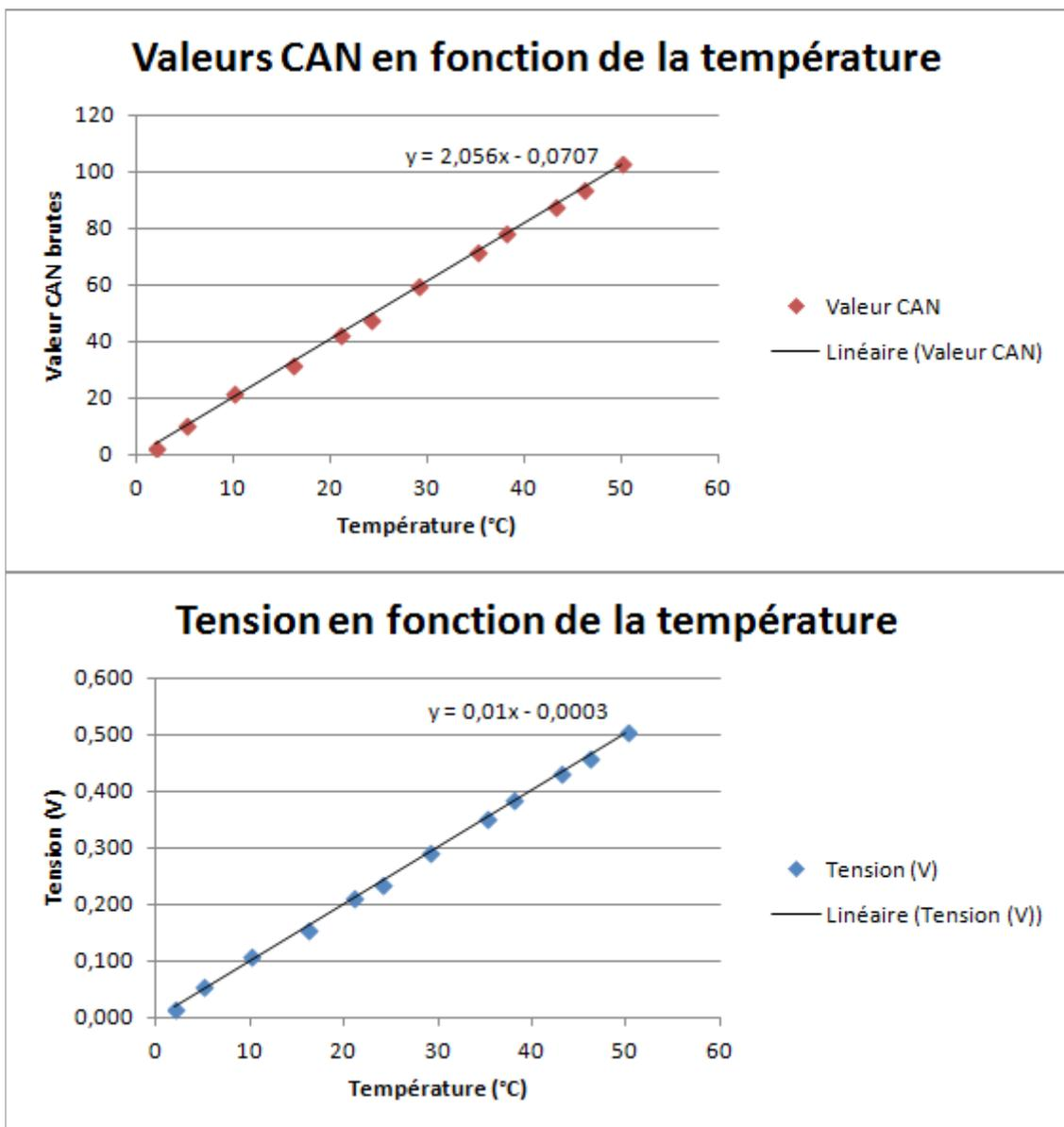
Grâce à l'équation, nous pouvons déterminer la relation liant la température et la tension (ou les valeurs du CAN). Ici nous obtenons :
