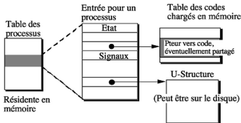
Création d'un processus sous Unix, réalisée par l'appel système fork :
