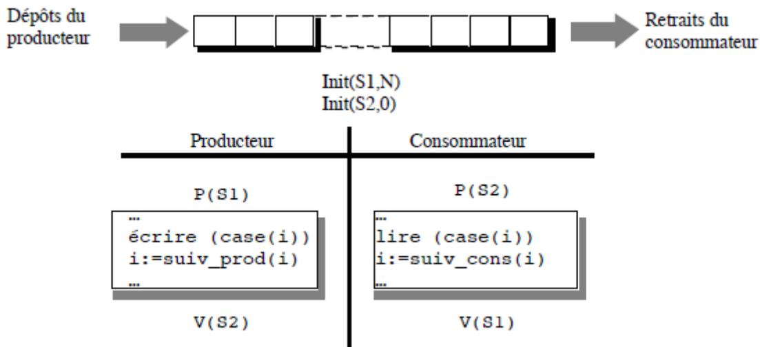
Ce type de synchronisation est mis en œuvre dans le système Unix sous forme de la primitive pipe. Celle-ci crée un fichier (appelé pipe, ou tube en français) à double accès qui ne peut être lu que si l'on a déjà écrit dedans et dans lequel on ne peut écrire que s'il y a des cases libres.
