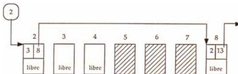
Exemple d'utilisation d'une liste chaînée pour la gestion de l'espace libre
