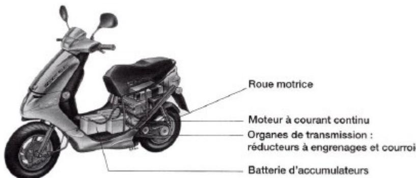
Un scooter est piloté par un conducteur qui au moyen d'une poignée peut modifier la vitesse de déplacement du scooter. La poignée envoie en fait une information à un microcontrôleur qui va gérer un modulateur d'énergie (hacheur) qui alimentera un moteur à courant continu, sous une tension moyenne variable.
